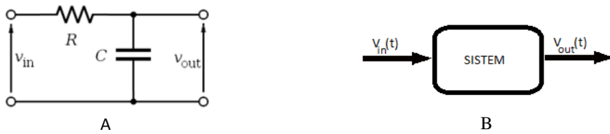
Figura 1. (a) Reprezentarea circuitului electric; (b) Modelul abstract corespunzător
