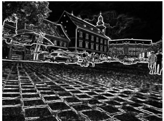
b. Extragerea contururilor folosind operatorul Prewitt
