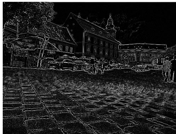
b. Extragerea contururilor folosind operatorul Laplace
