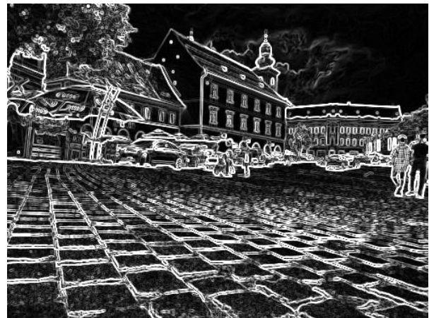
b. Extragerea conturilor folosind operatorul Sobel
